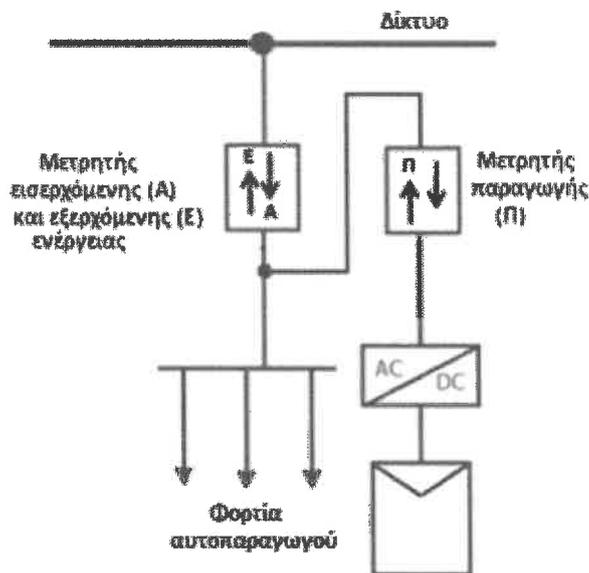
Εικόνα 3.3.3 Διάταξη εγκατάσταση μετρητών υπό καθεστώς NetMetering
